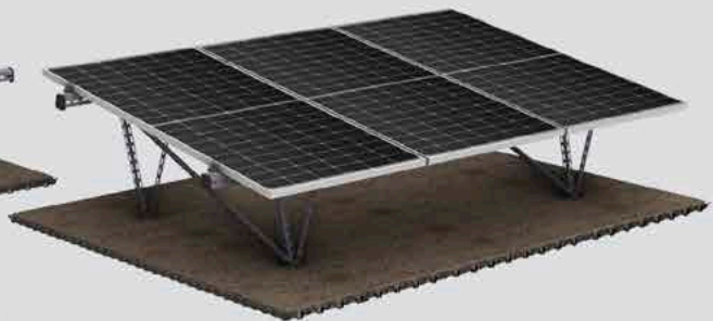
6 Photovoltaik Module mit Spannhaken-Sets befestigen
