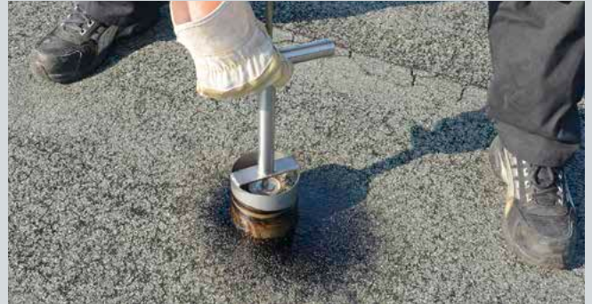
Abb. 17/1: Mit Spezialwerkzeug wird ein Schichtenpaket komplett ausgeschnitten.
