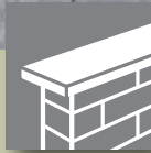
Mauerabschluss mit Abdeckplatten
