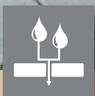
Sickerfugenpflaster: Abflussbeiwert C=0
