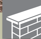
Mauerabschluss mit Abdeckplatten möglich
