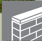
Mauerabschluss mit Abdeckplatten
