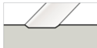
Nordic – Querschnitt Türblatt mit vertieften Profilen
