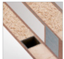
Klimaklasse III mit Stahlrohr- verstärkung oder Alumi- numverbundabsperung
