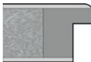
Kantenform Rundkante – 5 mm Radius ähnl. RAL 9010
