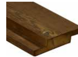
2378 Kebony Character Wechselfalzprofil 90° glatt** · 21 x 98 mm Deckbreite: ~ 78 mm Einsatz für geschlossene be- oder hinterlüftete Fassaden Montage: vertikal, sichtbar verschraubt
