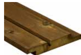
2596 Kebony Character Doppelprofil mit Wechselfalz K75** · 21 x 148 mm Deckbreite: ~ 128 mm* Einsatz für geschlossene be- oder hinterlüftete Fassaden Montage: horizontal und/oder vertikal, sichtbar verschraubt
