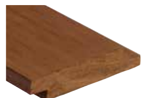
2453 Kebony Clear RAP mit Wechselfalz 90° · 19 x 120 mm Deckbreite: ~ 104 mm Einsatz für geschlossene be- oder hinterlüftete Fassaden Montage: vertikal, sichtbar verschraubt
