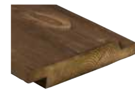
2240 Kebony Character Wechselfalzprofil 60° glatt** · 21 x 148 mm Deckbreite: ~ 131 mm* Einsatz für geschlossene be- oder hinterlüftete Fassaden Montage: vertikal, sichtbar verschraubt
