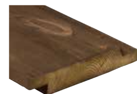
2594 Kebony Character Wechselfalzprofil K75** · 21 x 148 mm Deckbreite: ~ 128 mm* Einsatz für geschlossene be- oder hinterlüftete Fassaden Montage: vertikal, sichtbar verschraubt
