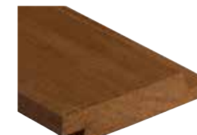
2597 Kebony Clear Wechselfalzprofil 75° · 19 x 120 mm Deckbreite: ~ 104 mm Einsatz für geschlossene be- oder hinterlüftete Fassaden Montage: vertikal, sichtbar verschraubt
