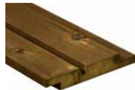
2242 Kebony Character Doppelwechselfalzprofil 60°** · 21 x 148 mm Deckbreite: ~ 131 mm* Einsatz für geschlossene be- oder hinterlüftete Fassaden Montage: horizontal, sichtbar verschraubt
