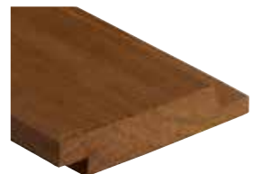
2451 Kebony Clear RAP Wechselfalzprofil 60° glatt · 19 x 120 mm Deckbreite: ~ 104 mm Einsatz für geschlossene be- oder hinterlüftete Fassaden Montage: horizontal, sichtbar verschraubt
