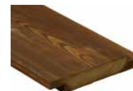
2216 Kebony Character Wechselfalzprofil 90° glatt** · 21 x 148 mm Deckbreite: ~ 128 mm* Einsatz für geschlossene be- oder hinterlüftete Fassaden Montage: vertikal, sichtbar verschraubt
