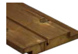
2339 Kebony Character Doppelwechselfalzprofil 90°** · 21 x 148 mm Deckbreite: ~ 131 mm* Einsatz für geschlossene be- oder hinterlüftete Fassaden Montage: vertikal, sichtbar verschraubt
