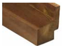
1217 Kebony Character Rhombusprofil Melsom · 61 x 48 mm Deckbreite: ~ 47 mm* Einsatz für geschlossene be- oder hinterlüftete Fassaden Montage: horizontal, sichtbar verschraubt
