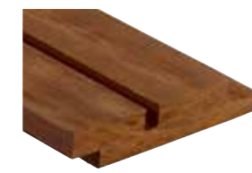
2598 Kebony Clear Doppelprofil mit Wechselfalz K75 · 19 x 120 mm Deckbreite: ~ 104 mm Einsatz für geschlossene be- oder hinterlüftete Fassaden Montage: vertikal, sichtbar verschraubt
