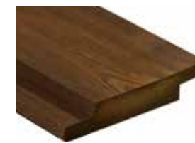
2380 Kebony Character Wechselfalzprofil 90°** · 21 x 123 mm Deckbreite: ~ 103 mm* Einsatz für geschlossene be- oder hinterlüftete Fassaden Montage: vertikal, sichtbar verschraubt
