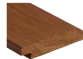
2649 Kebony Character Wechselfalzprofil K75 glatt** · 21 x 123 mm Deckbreite: ~ 103 mm* Einsatz für geschlossene be- oder hinterlüftete Fassaden Montage: horizontal und vertikal, sichtbar verschraubt
