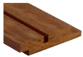
2454 Kebony Clear RAP Doppelprofil mit Wechselfalz 90° · 19 x 120 mm Deckbreite: ~ 104 mm Einsatz für geschlossene be- oder hinterlüftete Fassaden Montage: vertikal, sichtbar verschraubt
