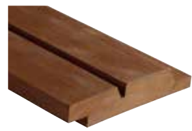
2452 Kebony Clear RAP Doppelprofil mit Wechselfalz 60° · 19 x 120 mm Deckbreite: ~ 104 mm Einsatz für geschlossene be- oder hinterlüftete Fassaden Montage: horizontal, sichtbar verschraubt
