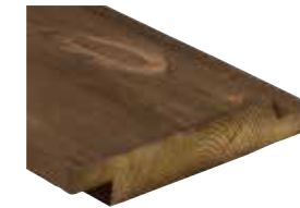
2651 Kebony Character Wechselfalzprofil K75 glatt** · 21 x 98 mm Deckbreite: ~ 77 mm* Einsatz für geschlossene be- oder hinterlüftete Fassaden Montage: vertikal, sichtbar verschraubt
